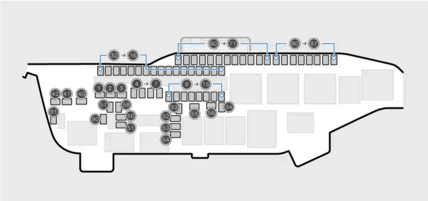
Diagram som visar säkringarnas placering
