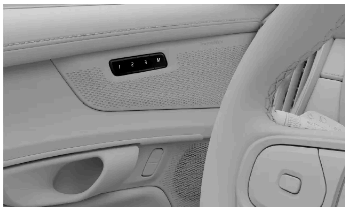
Placering av knapparna för förinställningar av sätesjustering
