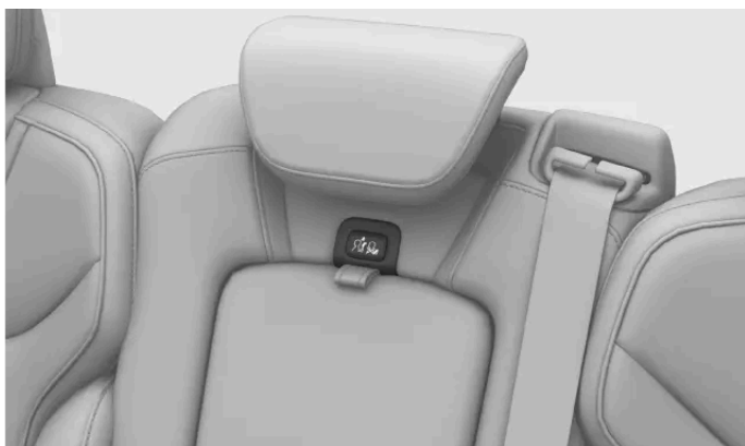
Låsknapp på det mittersta nackstödet
