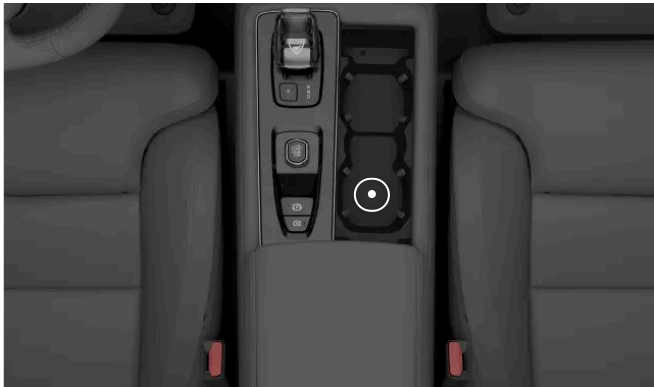
Placering av backup-läsaren i mugghållaren i tunnelkonsolen
