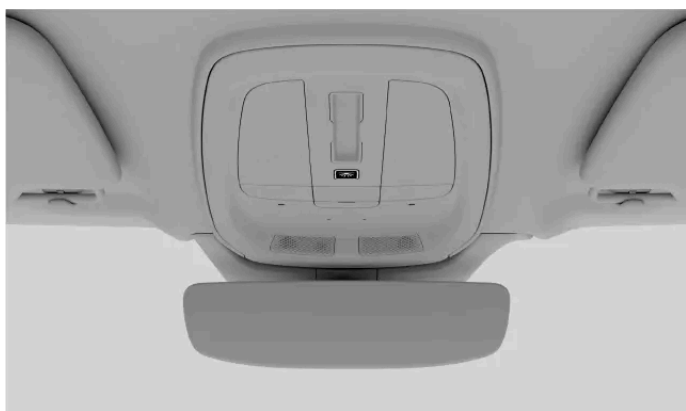
Automatisk belysning av-knapp i takkonsolen
